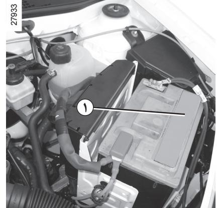
باتری بدون نیاز به سرویس و نگهداری
