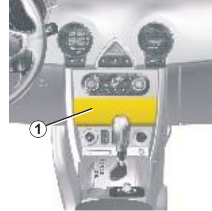
محل قرار گیری رادیو ۱ روکش خالی را باز کنید. آنتن، قطب + و - سیم اتصال بلندگو در پشت آن قرار دارد.
