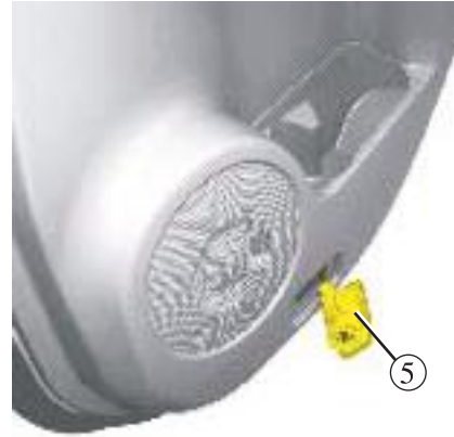
چراغ های در ۵ با استفاده از بیج گوشتی دو سو چراغ شماره ۵ را باز کنید. روکش شفاف را باز کرده و سپس لامپ را تعویض کنید. نوع لامپ : W5W
