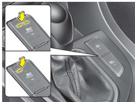
تیپ B (مجهز به سیستم تهویه هوا)
