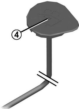
بررسی سطح مایع از "قیف" استفاده کنید، برای استفاده از آن سوراخ ۴ را با انگشتان نگه دارید، درپوش را بردارید سپس میله اندازه‌گیری متصل به درپوش را بخوانید.
